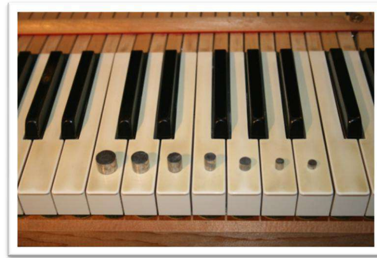
PIOMBI UTILIZZATI PER VARIARE IL PESO DEL TASTO
